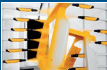
O OptiSpeeder está equipado com detecção de nível de pó e alimentação automática de pó fresco, o que garante uma quantidade de pó constante e sempre disponível.
