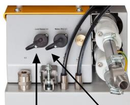
Conexão do sensor de nível
